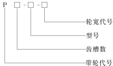
示例: 齿槽数 30, 型号 AT20, 轮宽代号 50 的带轮标记为:P30-AT20-50
