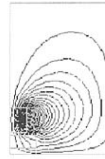
(e) d=2\text{mm} , R=20\text{mm} 时的磁力线分布
