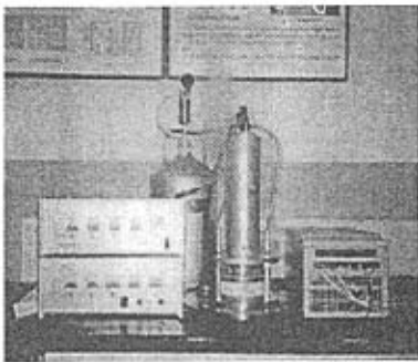
图 1-1 高温超导混合磁悬浮轴承样机试验系统装
