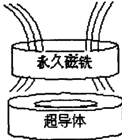
图 3-2 超导体抗磁性的解释
