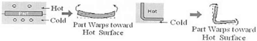
图 3.2.2 不均匀冷却对翘曲的影响 Fig 3.2.2 differential Cooling influence on warpage
