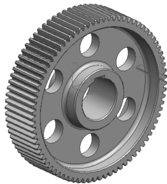
图 7 直齿渐开线齿轮
