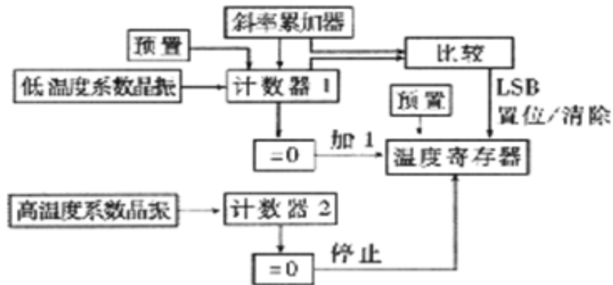
图 2 DS1820 测温原理框图
