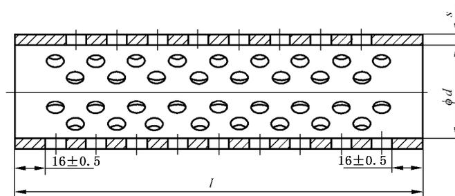
图 1 圆柱形筒管
