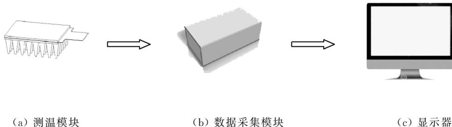
图 1 PCR 仪温度校准装置组成框图
