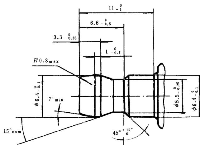
图1 整体式接线端
