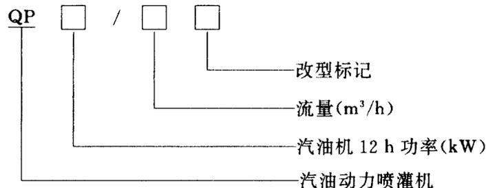
3.1.1 主参数有两个,即汽油机 12 h 功率值(写在斜线的左边)和喷灌机的流量值(写在斜线的右边),一律采用正体阿拉伯数字表示,高度与汉语拼音字母相同。
