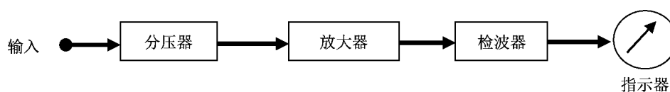
图 1 低频电压表原理图
