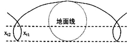
图 2-5 回转式成穴播种器入土端运动轨迹图
