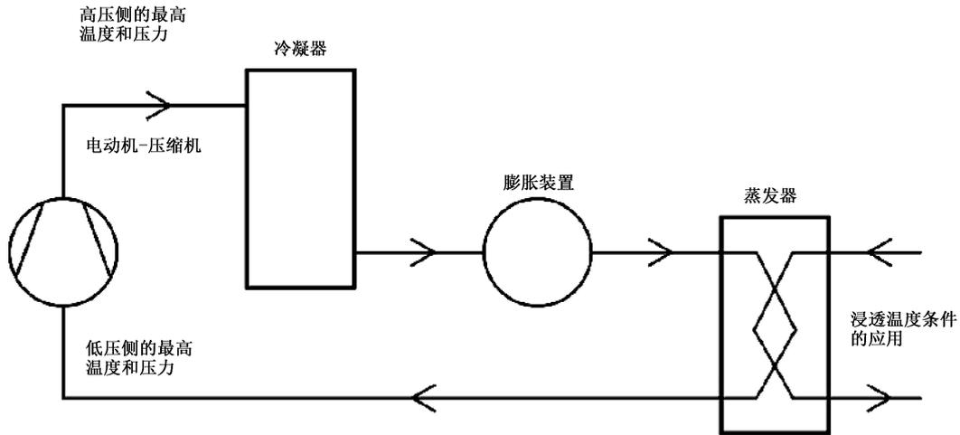
图 101 包含冷凝器的制冷系统示意图
