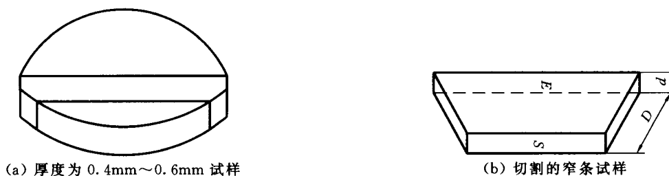
E 和 S —两平行解理面; d —原始试样厚度; D —试样测量厚度
