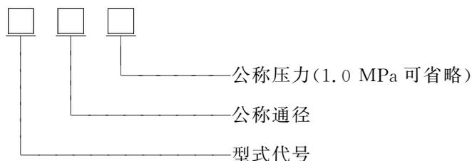
示例：公称压力为 1.0 MPa、公称通径为 100 mm 的吸水管接口标记为 KG100。
