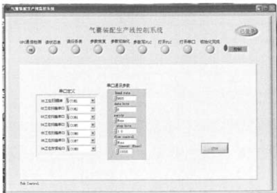
图 5.4 LabVIEW 与各工位扫描枪串口通讯参数定义
