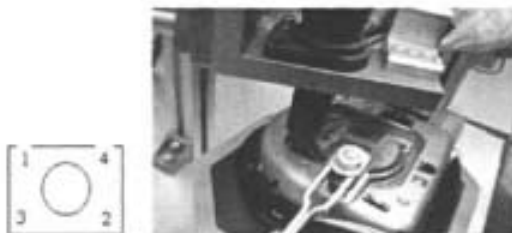
图 3.4 按照右图顺序拧螺母
