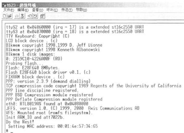
图 4-4 超级终端输出内核启动信息
