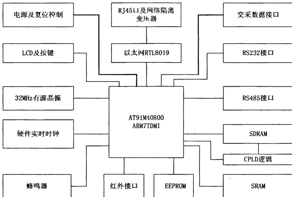
图 3-1 主控板硬件结构图
