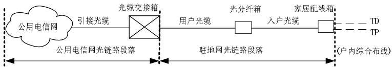
图 4.1.1 光纤入户系统结构示意图
