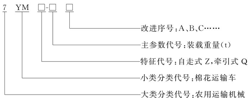
示例:自走式,装载重量为10 t、产品经第二次改进的运模车,产品型号应为7YMZ-10B。
