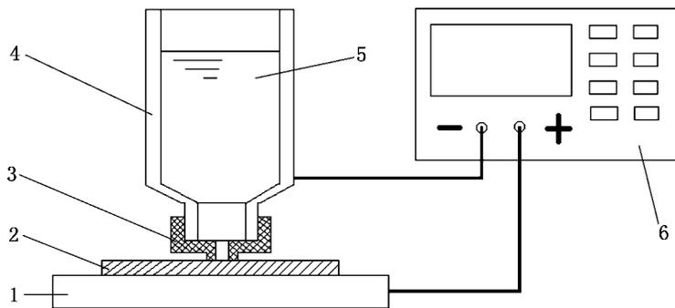
1—基体；2—镀层；3—橡胶密封圈；4—电解槽；5—电解液；6—控制单元。
