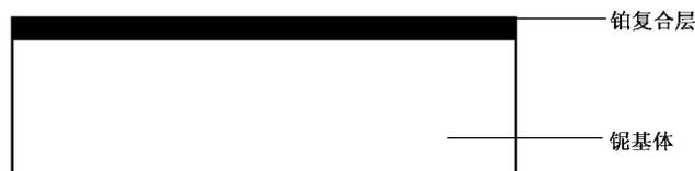
图 1 Pt/Nb 复合阳极板截面形状示意图
